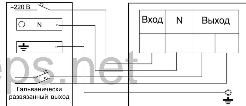
Рисунок 2 - Схема электрических соединений при подключении нагрузки к изолированному выходу
